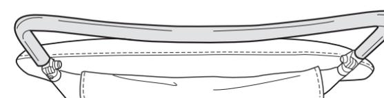
Si le cadre de l'appui-tête est installé à l'envers, les orifices des vis du cadre de l'appui-tête ne seront pas alignés sur ceux du cadre du dossier.
